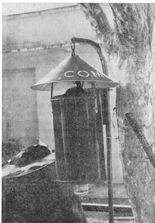
Fig. 1 — Armadilha luminosa automática modelo "New Jersey-50"
